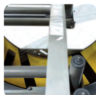
Doppelter Folien-Spulenträger Doppio sistema di portabobina per il film Двойная головка, несущая рулон с пленкой
